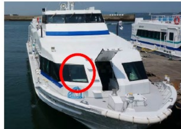
破損した前部客室右舷側の窓ガラス
