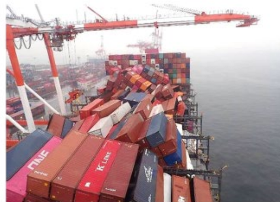
上甲板上コンテナの倒壊状況
