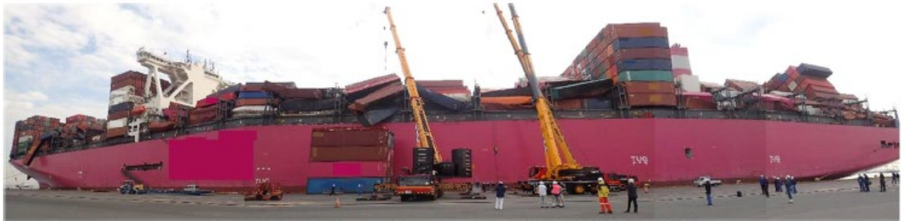
本船の左舷側から見たコンテナが倒壊した状況
