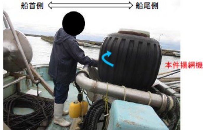
乗組員Aの右手が本件揚網機のゴムローラーに挟まれた時の状況 (再現)
