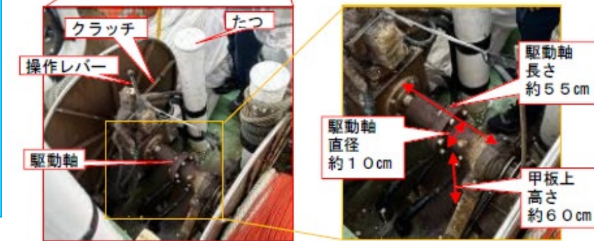
巻取機の設置状況 (本船船首部)
